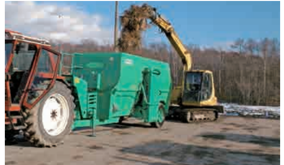
バイオチョッパー 畳、ワラなどの長物を裁断・攪拌します。
