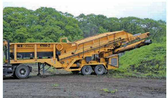
スタースクリーン 伐開物(ボサ)などから土砂を分離します。
